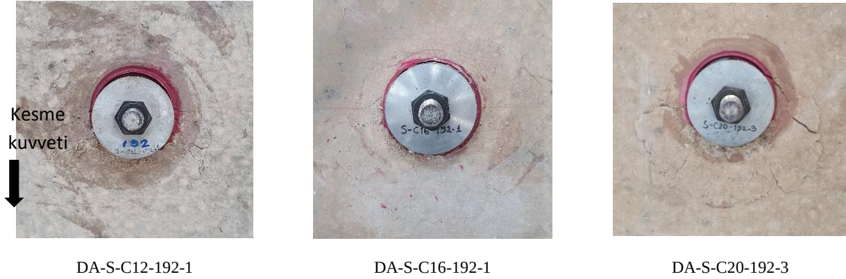
Şekil 6. Kesme deneyi sonrası tipik göçme modu.
